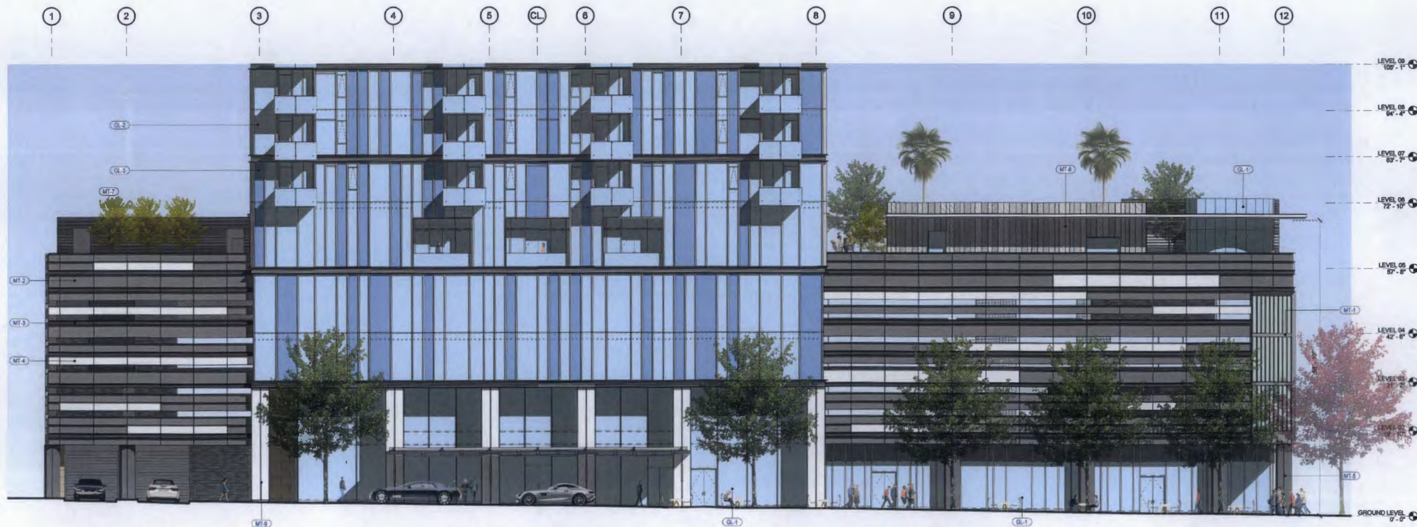
1 WEST ELEVATION PODIUM SCALE: 1/8" = 1'-0"
