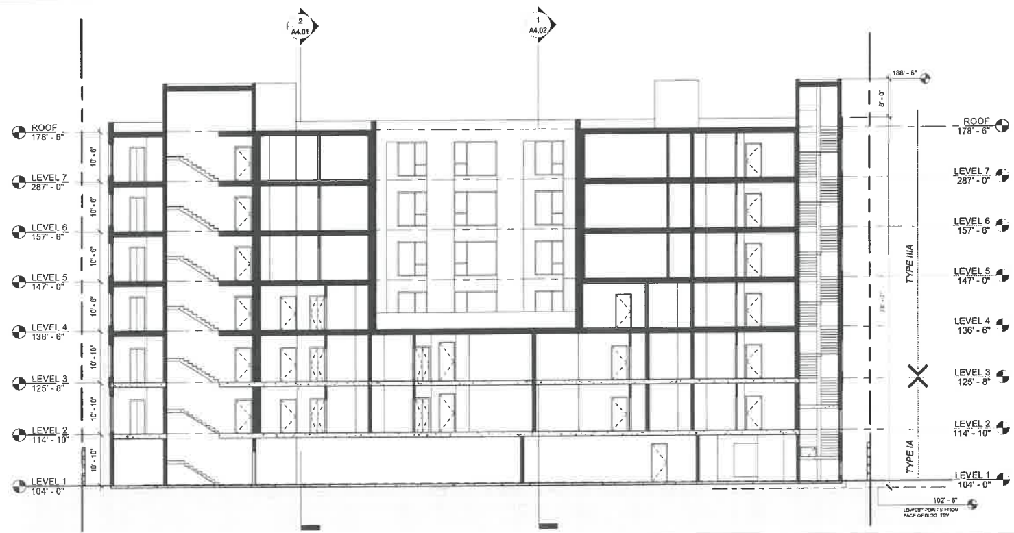
LONGITUDINAL SECTION A SCALE: 3/32" = 1'-0" 1
